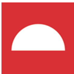
Andra brandskydds- anordningar eller brand- skyddsutrustningar
